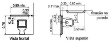
Imagens referenciais para instalação. Fonte: NBR 9050 Acessibilidade a edificações, mobiliário, espaços e equipamentos urbanos (figura 116, figura 118).
