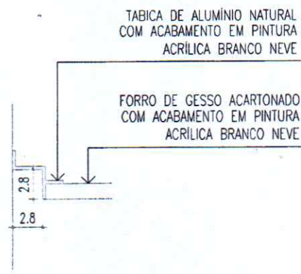
10 DETALHE TABICA DE GESSO ESCALA: 1:5
