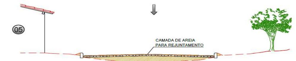
ANTES DA COMPRESSÃO COM O ROLO METÁLICO, JOGA-SE AREIA SOBRE O CALÇAMENTO, NA QUANTIDADE SUFICIENTE PARA PREENCHER AS JUNTAS E FORMAR UMA CAMADA SOBRE O CALÇAMENTO DE APROXIMADAMENTE 2CM.
