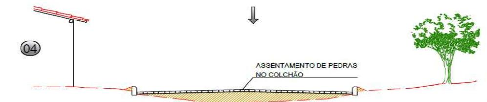
OS BLOCOS DE PEDRA TOSCAS SERÃO ASSENTES SOBRE O COLCHÃO DE AREIA EM LINHAS PERPENDICULARES AO EIXO DA PISTA, OBEDECENDO AS COTAS E ABAULAMENTOS DO PROJETO. EM TANGENTE, O ABAULAMENTO SERÁ FEITO POR DUAS RAMPAS, OPOSTAS A PARTIR DO EIXO, COM DECLIVIDADE DE 3% SALVO OUTRA INDICAÇÃO DO PROJETO. NAS CURVAS, A DECLIVIDADE TRANSVERSAL SERÁ A INDICADA PELA SUPER-ELEVAÇÃO PROJETADA
