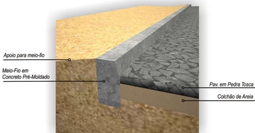
MÉTODO CONSTRUTIVO DE PAVIMENTO EM PEDRA TOSCA SEGUNDO A ESPECIFICAÇÃO DER-ES-P 18/94
