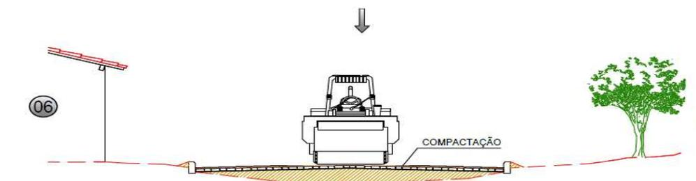
AS PEDRAS SOB A CAMADA DE AREIA DEVEM SER BATIDAS INICIALMENTE COM COMPACTADOR MANUAL TIPO PLACA VIBRATÓRIA E EM SEGUIDA PASSA-SE O ROLO COMPRESSOR, COMEÇANDO PELO PONTO DE MENOR COTA PARA O DE MAIOR COTA NA SEÇÃO TRANSVERSAL. O NÚMERO DE PASSADAS, ASSIM EXECUTADAS, É DE 3 VEZES NO MÍNIMO.
